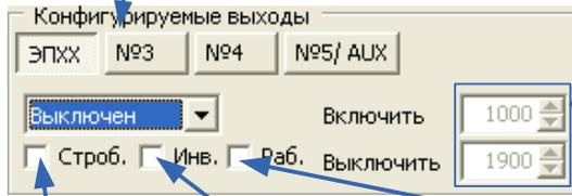
Пределы включения и выключения выбранного параметра.
